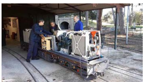
03 novembre - Primera posada en marxa del motor de la locomotora A2. Després es treballa amb la instal·lació elèctrica, el pentinat de cables i altres molts detalls
