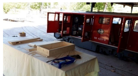
11 juliol - Renovades les fustes i envernissat a la locomotora BB4220-9.
