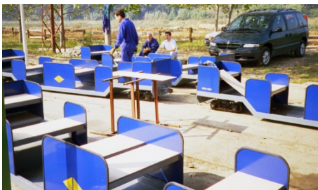
Amb les identificacions col·locades, es van adequar els seients amb unes fustes i evitar la fredor del ferro.
