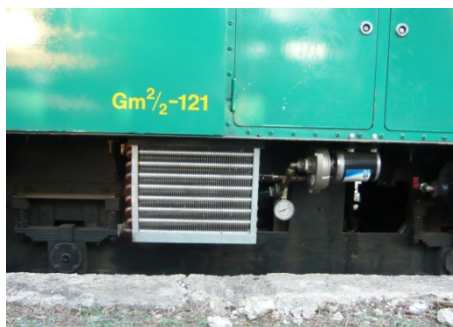
Vista de la nova bomba i el nou radiador a la locomotora A1.
